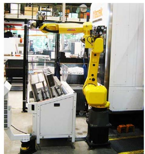
einfache, stupide Einlegearbeiten geschätzt und bei schwereren Werkstücken erübrigt sich das Beladen mit Kran.
