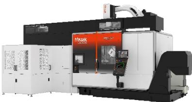
Die INTEGREX i-250H ist für eine Automation bestens geeignet. Durch die gerade verlaufende Front und das hinten angeordnete Werkzeugmagazin ergibt sich ein verbesserter Zugang für frontal angeordnete Werksautomatisierungssysteme. Dargestellt ist die INTEGREX i-250H ST mit dem Portalladesystem GANTRY LOADER (GL), welches die Be- und Entladung in der Großserienfertigung beschleunigt.
